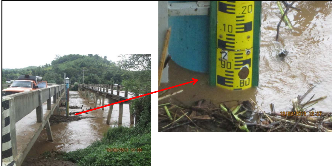
รูปที่ 78 รูปแสดงระดับน้ำที่ G.10 น้ำแม่ลาว อ.แม่สรวย จ.เชียงราย วันที่ 10 ส.ค. 56 เวลา 12:27 น. ระดับน้ำที่ 1.78 ม.
